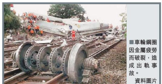
■車輪鋼圈因金屬疲勞而破裂，造成出軌事故。
