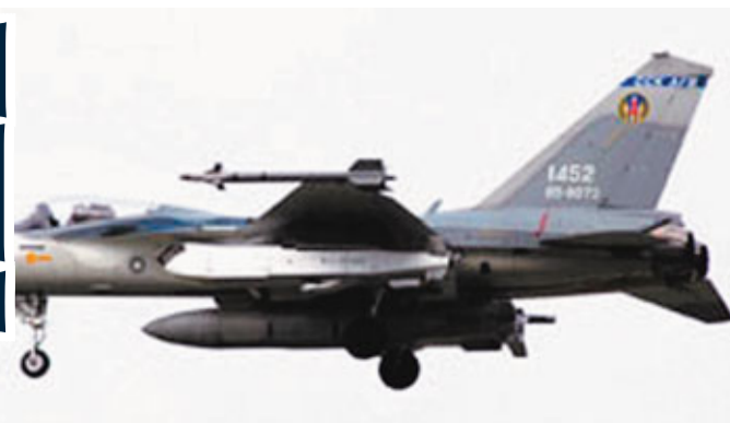
台灣自製掛載在IDF的「萬劍機場攻擊武器系統」，威力與射程及性能與JASSM類似。網上圖片
