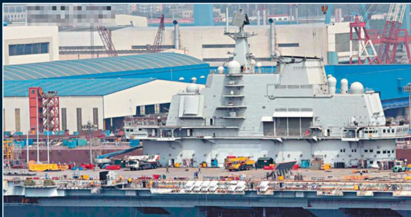
▲航母上大部分的建築支架已經拆下, 甲板變得整潔許多。船側的救生筏已經安裝。 網上圖片
