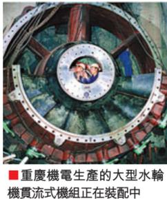
重慶機電生產的大型水輪機貫流式機組正在裝配中
