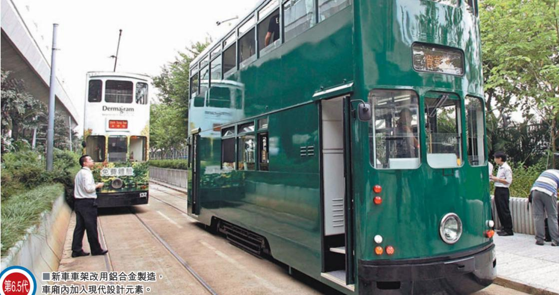
■新車車架改用鋁合金製造,車廂內加入現代設計元素。
