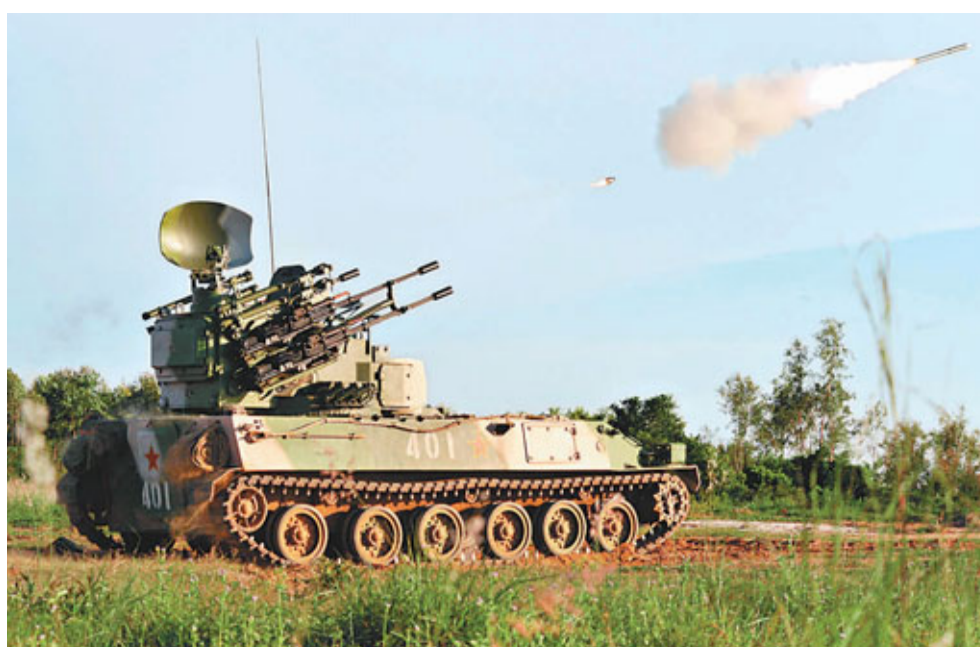
新型履帶自行高炮是防空導彈與高炮結合的防空武器系統。圖為導彈發射瞬間。
