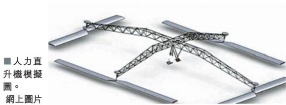
過去數十年來，人類曾製造出無數利用人力推動的飛機，但卻始終未有人成功讓單靠「腳踏」動力的直升機升空，原因是直升機的螺旋槳和普通定翼機的飛行模式，對動力要求相差甚遠。美國馬里蘭大學50名工程師就經過兩年努力，準備在今日挑戰壯舉。他們研發的人力直升機名為「蓋默拉」，機身長18米，相當於1/3個足球場，每支旋轉翼則長13米。機身採用碳纖維、發泡膠及輕質木材，重量只有140磅。直升機無固定機翼，難以持久飛行，而且單靠推動力只能離地，不可向前。要做到兩者皆能，所需動力是正常飛機的15倍。若他們成功將直升機離地3米並持續1分鐘，便可獲得「西科爾斯基獎」頒發的25萬美元(約194萬港元)獎金，留名史冊。■《每日郵報》
