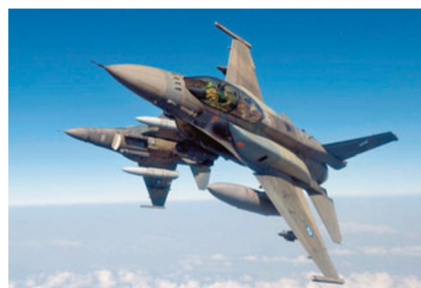
裝有保形油箱的美製最新款F16 Block 50戰機，可擴作戰半徑，卻在印度市場上敗北。網上圖片
