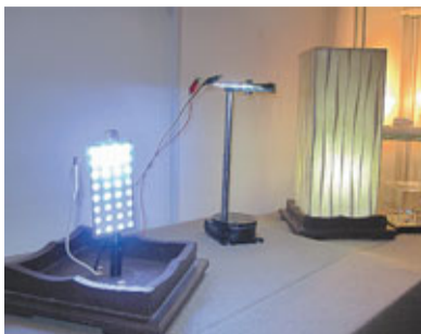
▲「超級省電LED燈」設計原理是將LED晶片平面排列,能夠將光源集中,助散熱。
