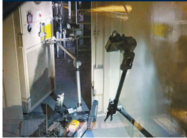
壯士出動一個月以來，東電昨日終於以機械人「Packbot」到反應堆廠房檢測輻射。
