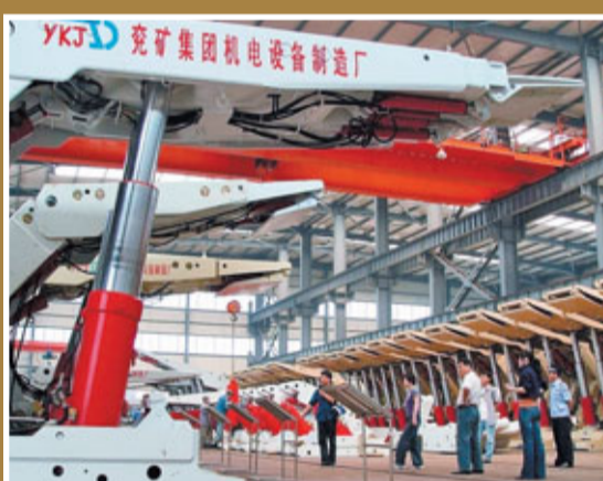
兗礦集團研製生產的我國第一套應用於600萬噸採煤工作面，具有自主知識產權的ZF8500型液壓支架。
