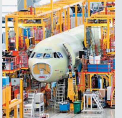
■空客員工在天津總裝線進行飛機機頭的安裝作業。 資料圖片
