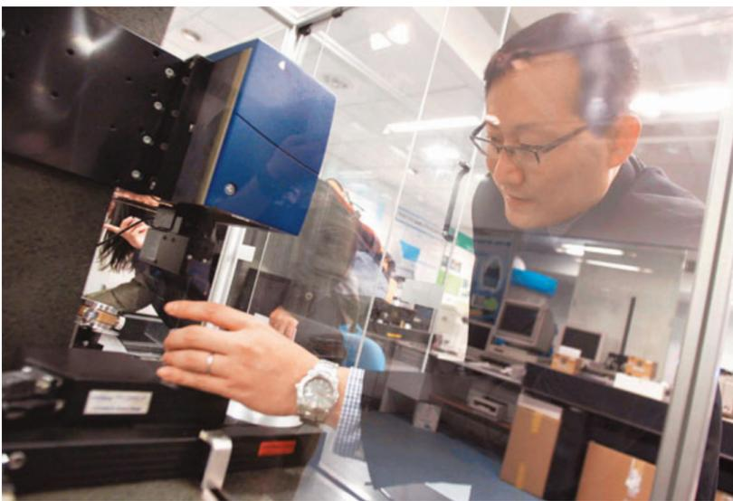
張志輝表示,業界過去主要靠技師經驗,判斷所需的切削技術和加工條件,但往往因為加工條件控制失當,影響「表面生成」的效果,「不同金屬材料,以不同的切削速度、鑽石的振動頻率等,可達到不同的『表面生成』效果」。由於缺乏系統化數據,技師往往需要進行多次實驗性切削,才能造出較理想的效果。張志輝形容,傳統加工過程無異於「撞彩」,由於每柄鑽石刀具動輒數萬元,使用上百次便告報銷,令生產成本大增。
