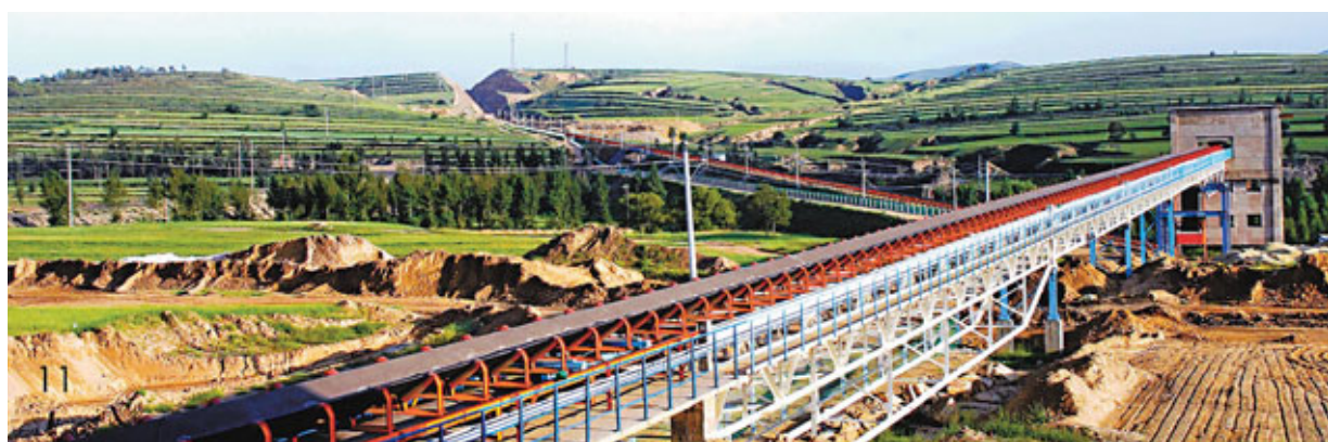
中煤海洋集團在山陰縣投資建設循環工業園區，圖為亞洲第一長全封閉輸煤專線。
