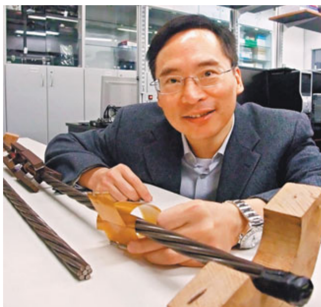
謝偉達研發的柔性印刷磁線圈，可以靈活地套用於不同寬度的纜索，透過電磁波，一秒內便可檢測到纜索有否裂紋。 香港文匯報記者歐陽子瑩攝
