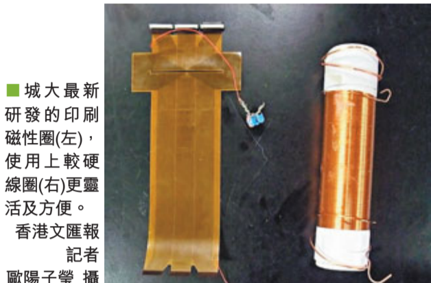
城大最新研發的印刷磁線圈(左)，使用上較硬線圈(右)更靈活及方便。 香港文匯報記者歐陽子瑩攝
