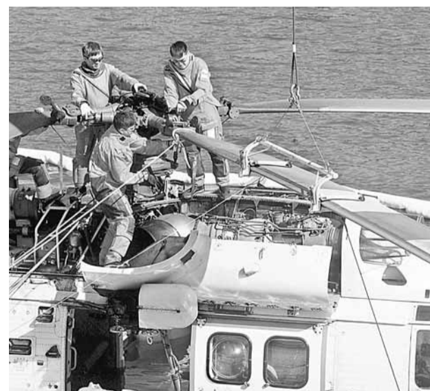
工程人員拆除主引擎。 香港文匯報記者劉國權攝
