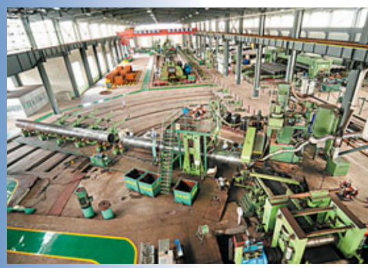
螺旋縫埋弧焊管生產線全貌
