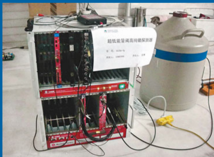
■用於探測暗物質的超低能量高純鍍探測器。
