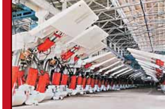
■內蒙古北方重工集團正在調試中的液壓支架臂。
